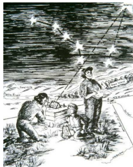
Рис. 9. Використання секстанта і ртутного штучного горизонту під час експедиції Джона Чарльза Фрімонта
